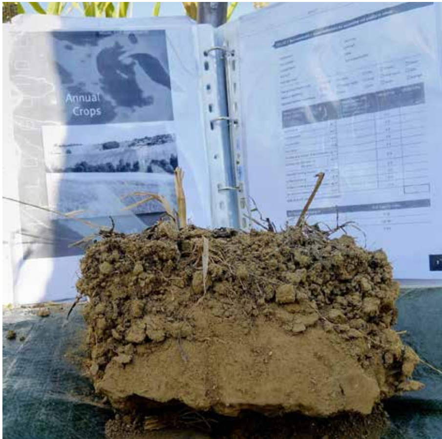
Figura 19: Cubetto di suolo prelevato con la pala e corrispettiva scheda VSA utilizzata per la valutazione.
