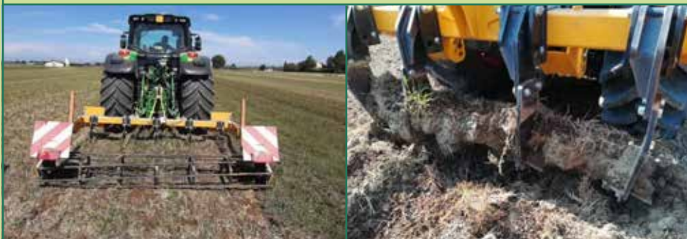
Figura 9: Decompattatore Combiplow con lama TCS 550 SILVER, utilizzato per la lavorazione principale nel periodo estivo in condizioni di tempera del suolo. La particolare conformazione delle lame permette una fenditura verticale senza alterare la disposizione degli orizzonti di suolo. Società Agricola Biologica Fileni, Falconara Marittima (AN), annata agraria 2019/2020.
