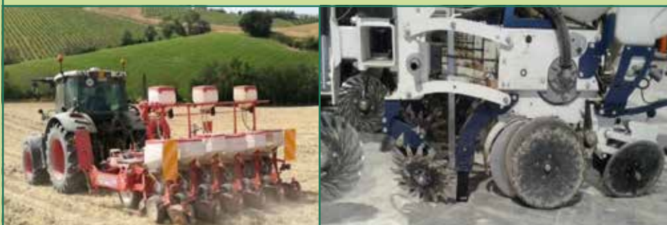
Figura 12: Seminatrice monogerme dotata di Kit accessori per la semina diretta del sorgo dopo la devitalizzazione delle colture di copertura (miscuglio: senape bianca, orzo, favino). Azienda agricola F.lli Bucci, Serra de' Conti (AN), 03/06/2019.
