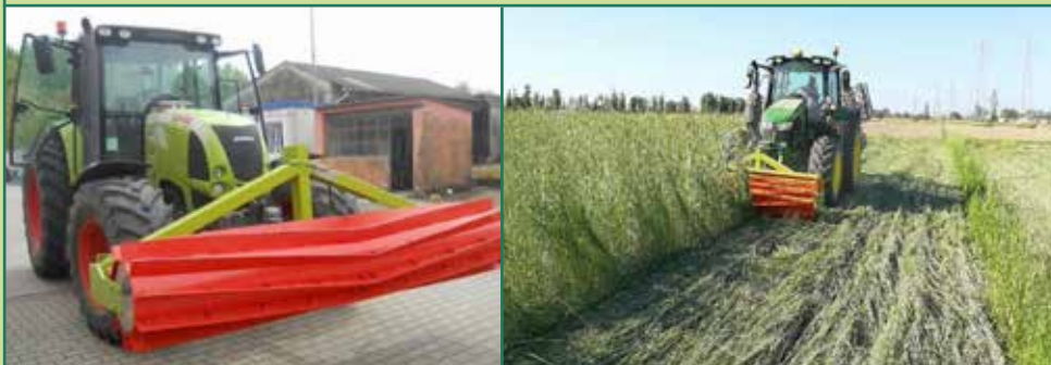
Figura 13: Roller crimper per la terminazione-allettamento della segale utilizzata come coltura di copertura. Società Agricola Biologica Fileni, Falconara Marittima (AN), 18/05/2022.
