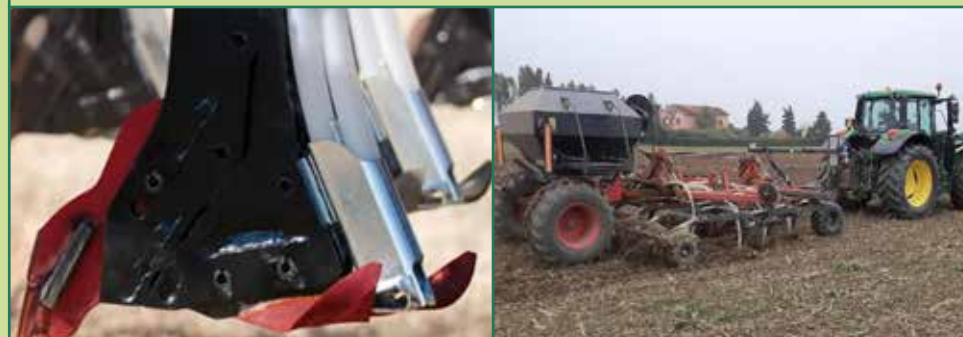
Figura 11: Seminatrice pneumatica ad ancore AS-UST450. Le ancore brevettate garantiscono sia la corretta deposizione del seme nel suolo, senza metterlo a contatto con i residui colturali, sia l'efficace azione di diserbo meccanico. Società Agricola Biologica Fileni, Falconara Marittima (AN), 28/11/2020.
