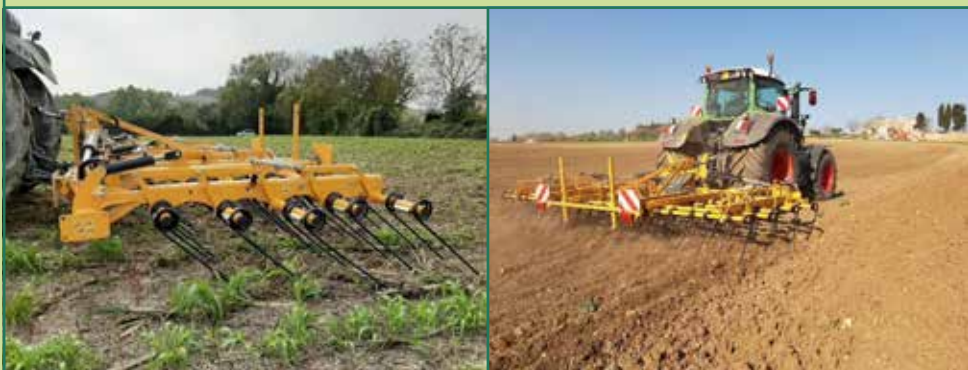
Figura 10: Strigliatore pesante Turbomulch utilizzato per la gestione dei residui colturali in fase di post-raccolta, per la devitalizzazione della flora spontanea e per affinare il suolo in fase di presemina. Società agricola Tenuta di Tavignano, Cingoli (MC), 07/04/2020.
